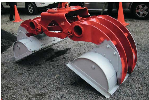
ドラム缶とスクラップ用クレーンによる油回収装置の動作確認
