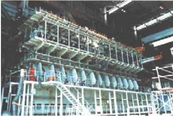
70,000馬力を超える船用大型ディーゼルエンジン
